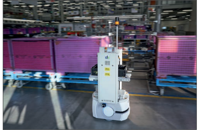
Acil küçük parçaların teslimatı, STR'nin daha küçük bir sürümü (Omron LD mobil robotunu temel alan miniSTR) tarafından gerçekleştirilir.
