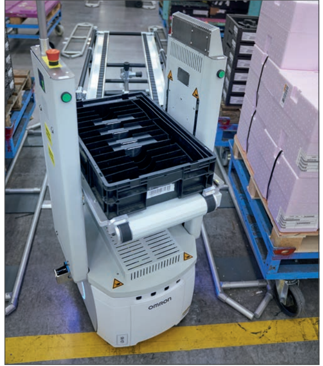
Bu otonom mobil robotlar, sistem entegratörü cts GmbH tarafından geliştirilen, yüksekliği ayarlanabilir bir yük taşıma cihazı olan konveyör kulesi ile donatılmıştır.
