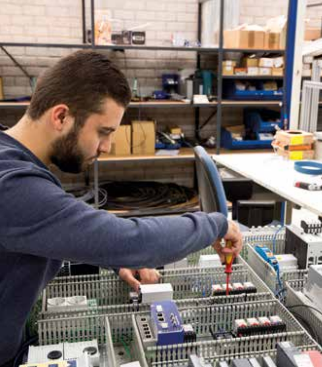
Push-In Plus teknolojisi kontrol panolarının daha kolay ve hızlı kablolanmasına olanak sağlıyor
