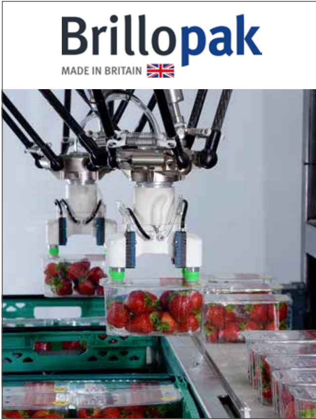
Brillopak her bir şalenin dört kollu Omron Delta robot ile doğru konuma yerleştirilmesini sağlayan benzersiz bir "tek seçme" konsepti geliştirdi.
