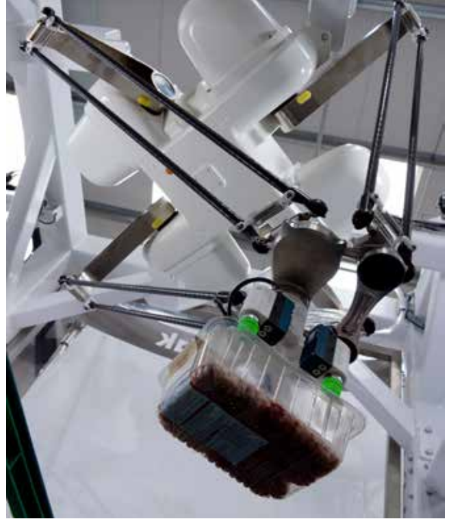
Sisteme yeni bir şale boyutu dahil edildiğinde ürün tedarikçisi paketleme düzeni şablonunu çevrimdışı olarak kolayca geliştirebiliyor ve böylece hat değişikliği sırasında yaşanan duruş süresini önemli ölçüde azaltıyor.
