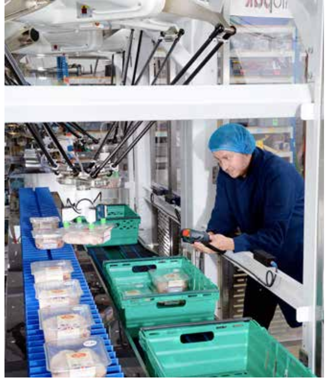
Brillopak Meteor hattında iki Omron Quattro Delta robot yer alıyor.
