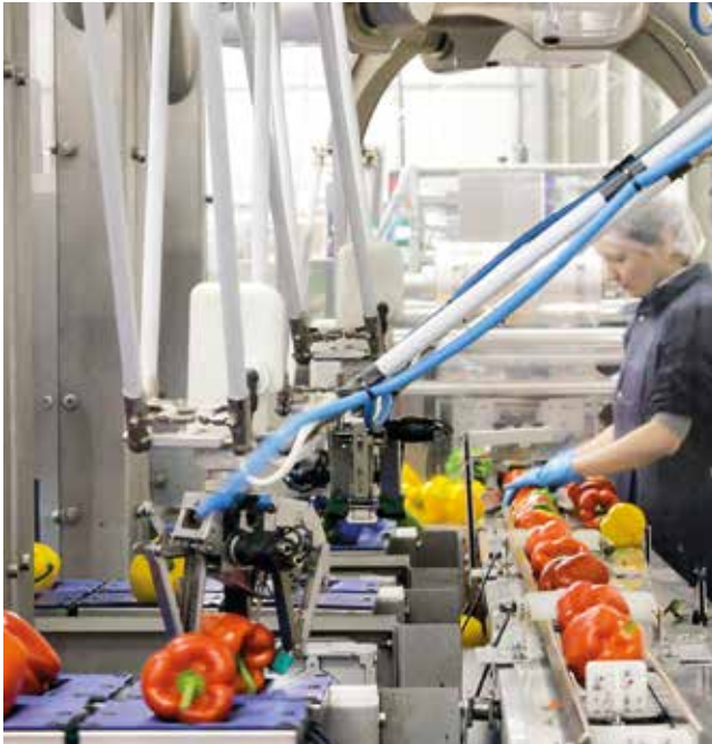
Robotlar, dolmalık biberleri alıyor ve doğru renk sıralamasında banda düzgün şekilde yerleştiriyor.
