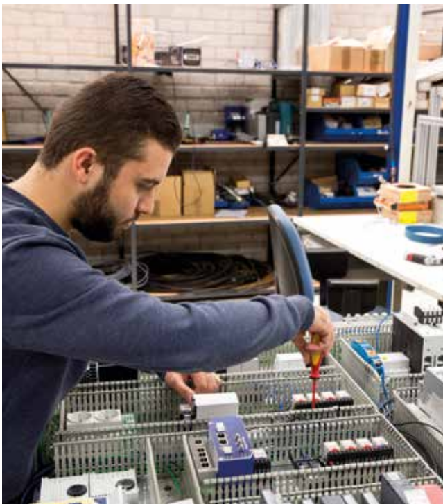
Push-In-Plus-teknik gör att kabeldragning för kontrollpaneler går betydligt enklare och snabbare.
