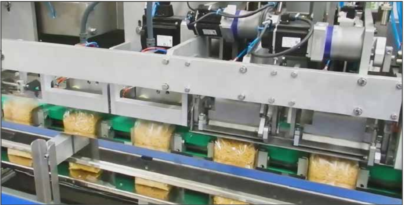
System MCRS-VD firmy Martini może zapakować do 180 porcji makaronu na minutę w opakowaniach typu pillow.
