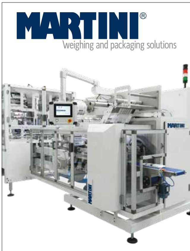
Martinis nye HFFS-system (Horizontal Form Fill and Seal) er 10 % raskere i produksjon blant annet takket være Omrons nye NJ501-1400 Sysmac-maskinkontroller.
