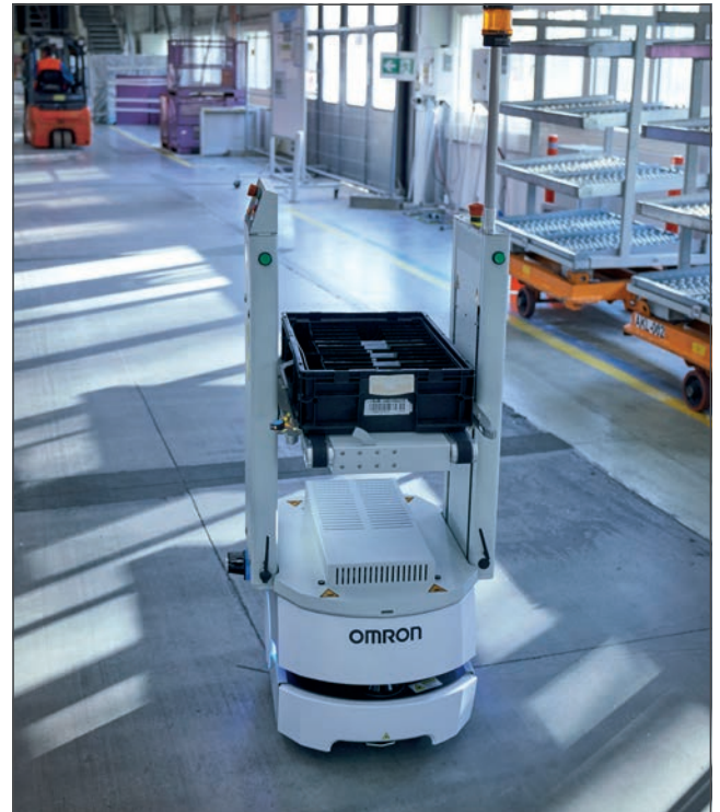
Het Fleetmanagement-systeem Omron Enterprise Manager zorgt ervoor dat producten, zodra ze klaar zijn, van de ene productiefase naar de andere worden getransporteerd.
