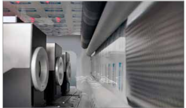
I caratteri, incisi per asportazione laser di un rivestimento colorato su uno strato inferiore di alluminio argentato, vengono "letti" con una precisione prossima al 100%
