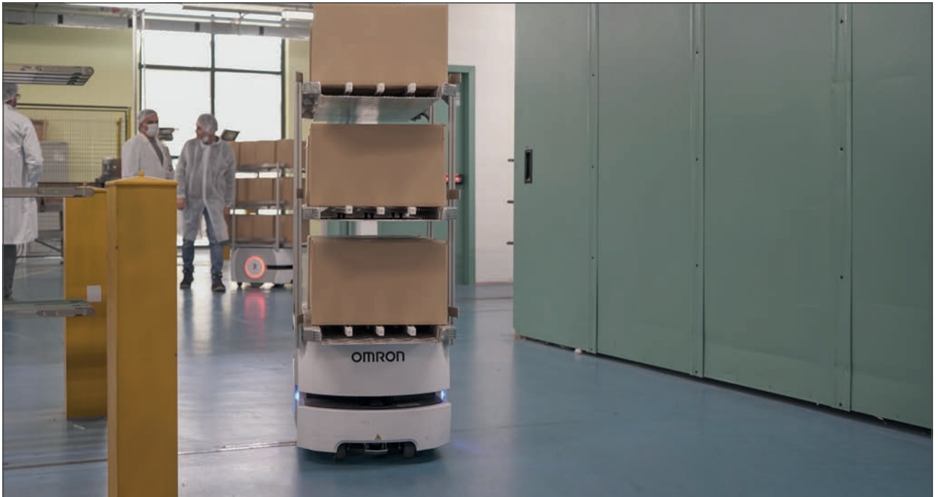
FM Vision ha fornito una soluzione completamente automatizzata basata sull'impiego di cinque robot mobili autonomi (AMR).
