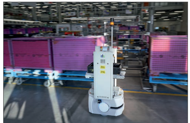
Les robots mobiles autonomes sont équipés d'une tour de convoyeur ; un dispositif de manutention de charge réglable en hauteur, développé par l'intégrateur de systèmes cts GmbH
