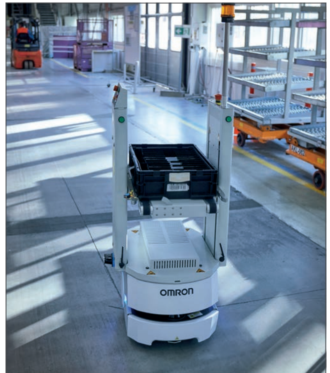
La livraison de petites pièces urgentes est gérée par une version plus petite du STR, le miniSTR basé sur le robot mobile LD d'Omron.
