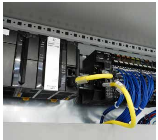
Omronin NJ501-1400 Sysmac -koneohjain mahdollistaa joustavamman tuotannon.
