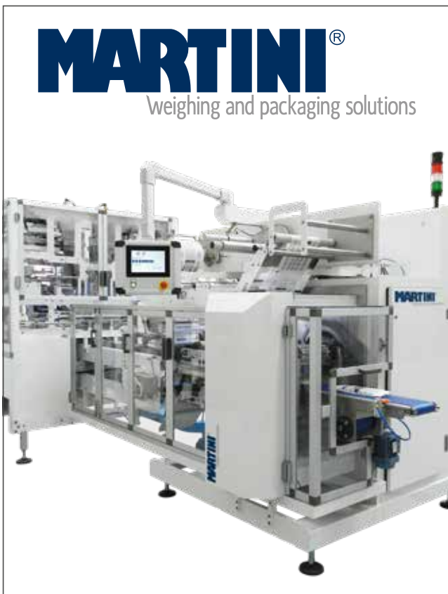
Martinin uusi horisontaalinen muotoilu-, täyttö- ja saumausjärjestelmä (HFFS) on lisännyt yhtiön koneiden pakkausnopeutta 10 % – ja se on osaksi Omronin NJ501-1400 Sysmac -koneohjaimen ansiota.
