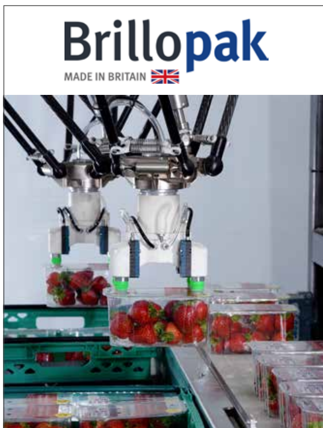
En Brillopak han desarrollado un exclusivo concepto de "recogida individualizada" que carga cada bandeja en el lugar correcto de la caja.
