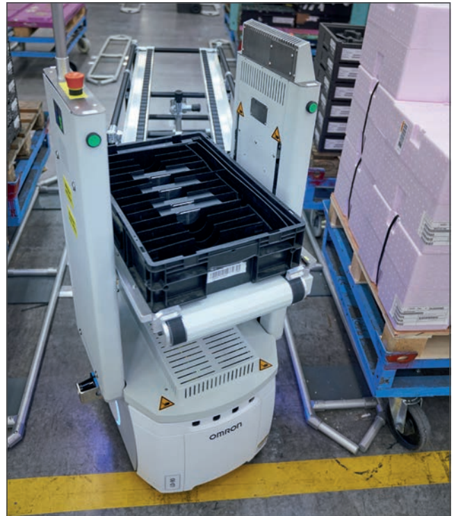
Dodávku urgentních drobných dílů zajišťuje menší verze robota STR, model miniSTR založený na mobilním robotu Omron LD.
