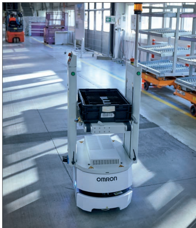
Systém správy vozidel Omron Enterprise Manager se stará, aby byly produkty dopraveny z jedné fáze výroby do další, jakmile budou připraveny.
