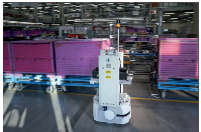
Tyto autonomní mobilní roboty jsou vybaveny výškovou nástavbou s dopravníkem, kterou lze při manipulaci s nákladem výškově nastavovat. Nástavbu vyvinul systémový integrátor, společnost cts GmbH.
