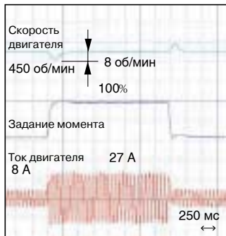
Компенсация внезапных изменений в нагрузке (характеристика восстановления скорости при скачках нагрузки)
