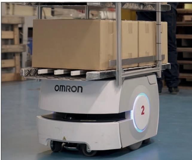
*Diva International ha aggiornato le sue linee di produzione con un nuovo impianto di pallettizzazione per le sue salviette umidificate che sfrutta un machine controller e cinque robot mobili autonomi (AMR) di OMRON. Risultato: un processo più sicuro ed efficiente, che tiene traccia di tutti gli step di lavorazione, dall'ordine fino all'evasione in magazzino*
