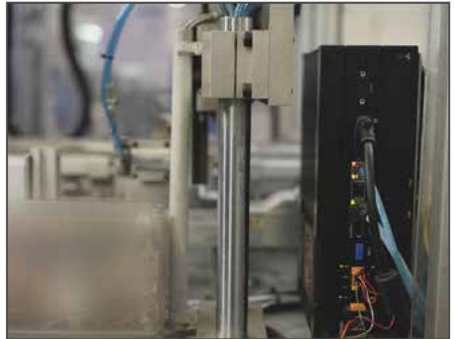
contrôleur IA est qu'il peut être synchronisé avec la machine et intercepter les données à la **milliseconde près**. Le contrôleur IA peut ainsi détecter les irrégularités de manière très précise et fournir un feedback immédiat. Cela donne lieu à une présentation incroyablement détaillée du processus :
