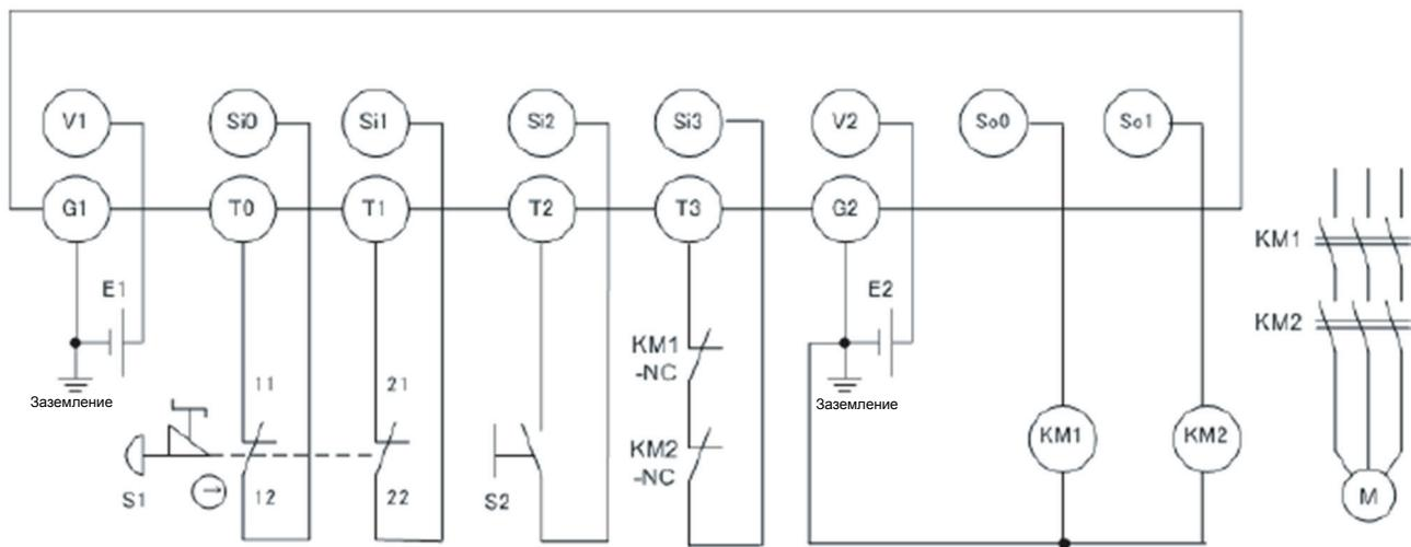
E1 и E2: Импульсный источник питания 24 В постоянного тока (Напр., OMRON S8VS)
