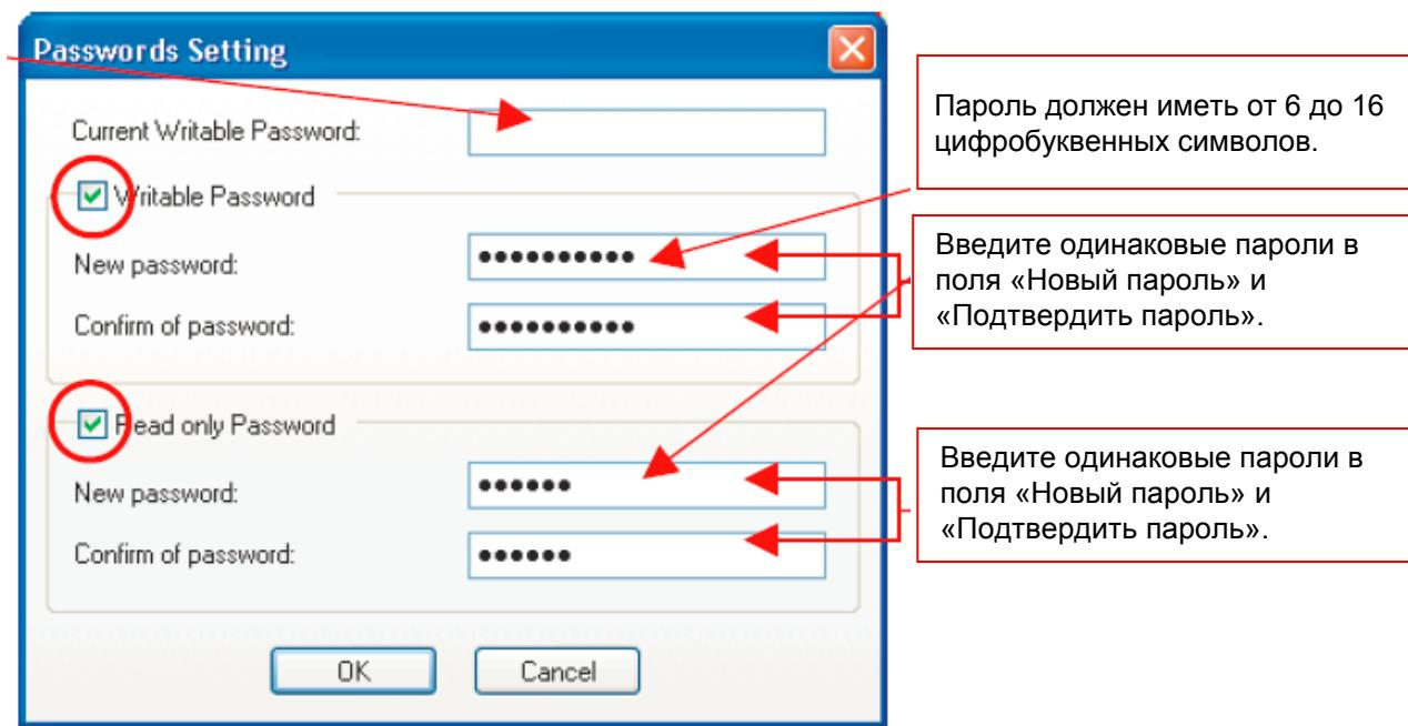
Подключите контроллер серии G9SP и установите пароль для устройства.
