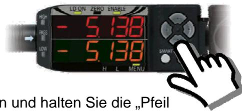
Drücken und halten Sie die „Pfeil abwärts“ Taste für 3 Sekunden. Um die Funktion abzuschalten drücken und halten sie die „Pfeil abwärts“ und Pfeil aufwärts“ gleichzeitig für 3 Sekunden.
