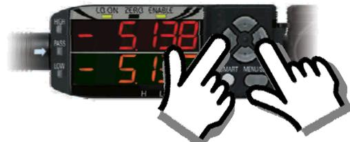
Drücken und halten Sie die "Pfeil rechts" und "Pfeil links" Tasten gleichzeitig für 3 Sekunden um die Tastensperre ein- und wieder auszuschalten.
