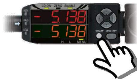
Drücken und halten Sie die "Smart" Taste für 1 Sekunde um „Single Smart Tuning“, 2 Sekunden um „Multi Smart Tuning“ und 5 Sekunden um „Active Smart Tuning“ durchzuführen.
