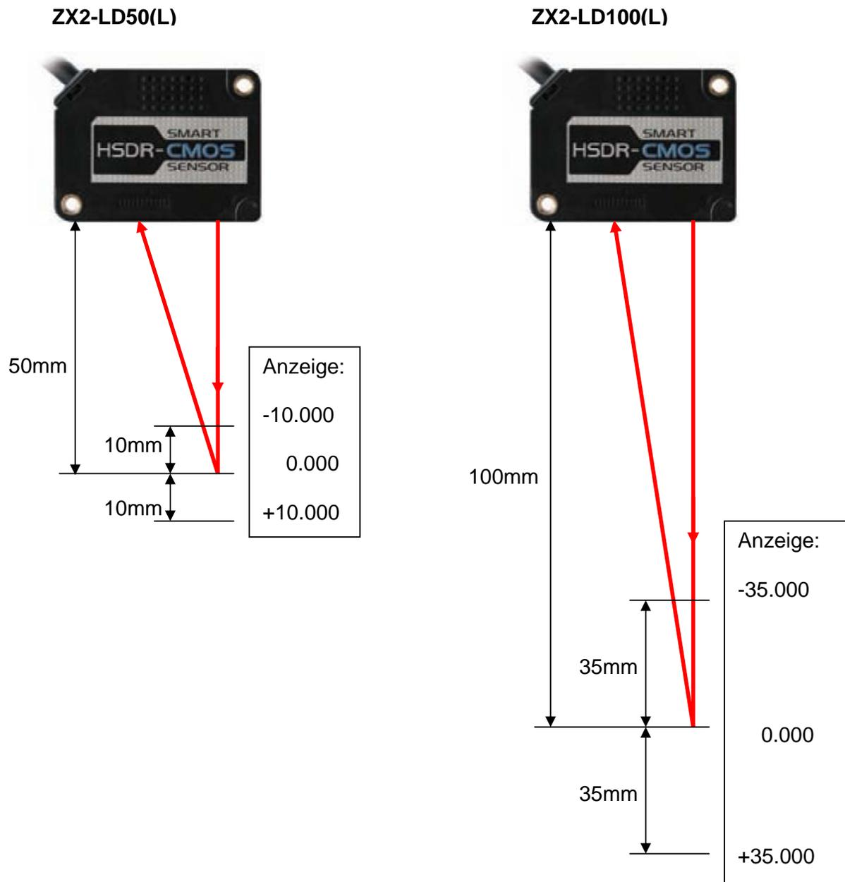
Der Analogausgang kann für folgende Ausgangsbereiche konfiguriert werden (s. S.11 und S.12 für zusätzliche Einstellungen):
