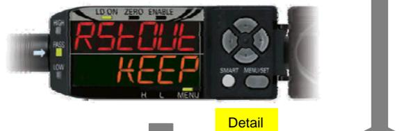
Einstellung des "Clamp" Wertes für den Analogausgang (Klemmenspannung) S. S. 12.
