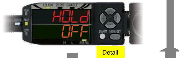
Wahl des Ausgangsbereiches für den analogen Ausgang (-5V-5V, 1-5V oder 4mA-20mA)
