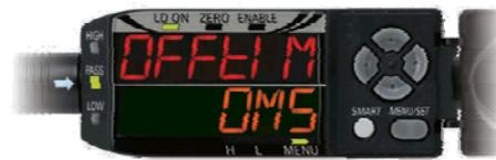
Wahl ob der "Zero Reset" Zustand permanent oder flüchtig gespeichert werden soll (nach Wegfall der Versorgungsspannung).
