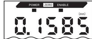
Die Nullsetzung wird aufgehoben und die Anzeigeleuchte für Nullsetzung (ZERO) erlischt.
