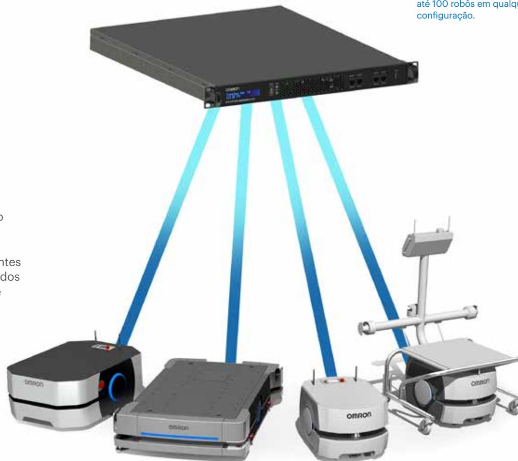
Com o software FLOW Core, o Fleet Manager da OMRON é capaz de gerir frotas de até 100 robôs em qualquer configuração.
