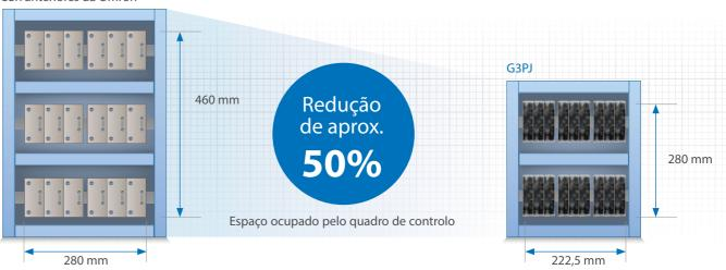
Exemplo: instalação de 18 SSR configurados para aquecedores trifásicos (6 canais)
