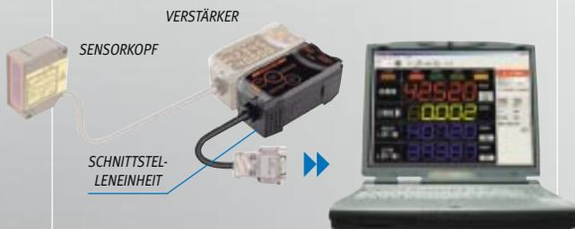
Das SmartMonitor-Programm ermöglicht die bequeme Einrichtung des Systems über PC oder Notebook.
