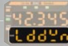
Die integrierte Überwachung der Laserleistung warnt bei einem Abfall der Laserleistung.
