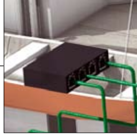
MRP yöneticisi olan bir switch, PROFINET uyumlu yedek halkasını kontrol eder.
