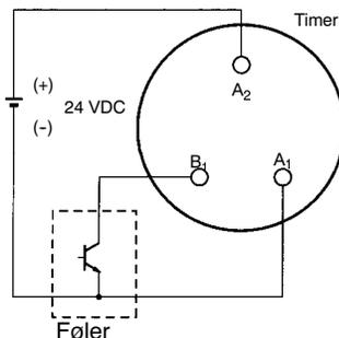
I drift med NPN transistor ON
