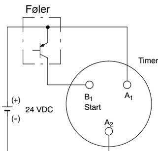
I drift med PNP transistor ON
