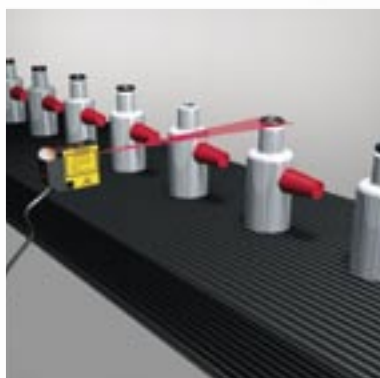
Presenza di O-ring nel processo di montaggio
