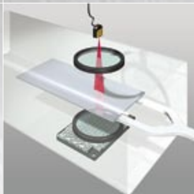
Rilevamento di oggetti attraverso portelli di osservazione in vetro
