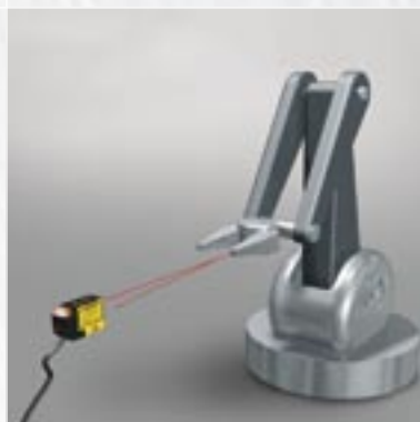
Ripetizione dell'autoimpostazione di posizionamento del braccio meccanico per la calibrazione
