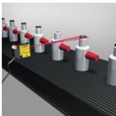
Tömítés (O-gyűrű) meglétének ellenőrzése a gyártósoron
