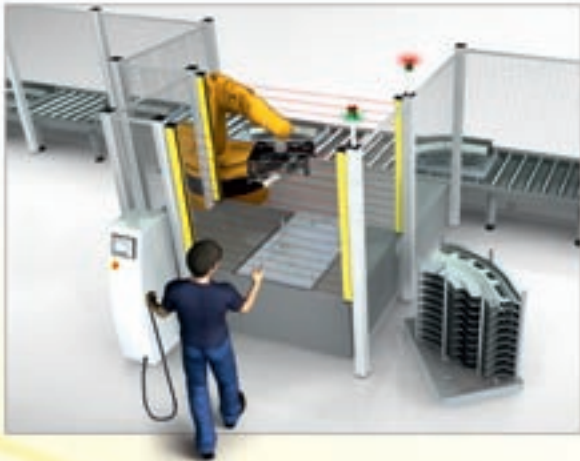
A4EG-sallintakahvan suora kytkentä tukee turvallisia huolto- ja asennustoimenpiteitä
