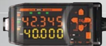
El doble display de fácil lectura muestra los resultados de las mediciones o la configuración de las diversas funciones.
