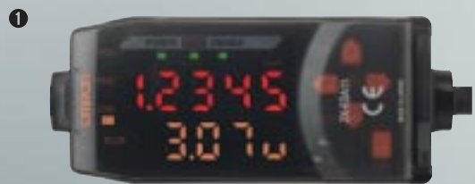
Die leicht ablesbare zweizeilige Anzeige zeigt Messergebnisse oder Einstellwerte an.
